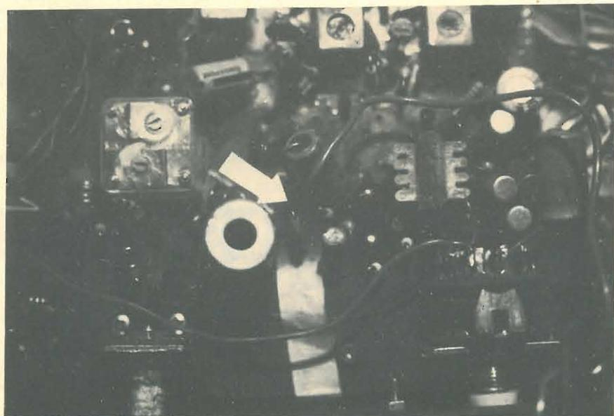
La sonda non è altro che un corto spezzone di filo terminante alle due estremità con condensatori ceramici da 470 pF, uno collegato alla seconda antenna, l'altro fissato con una goccia di collante epossidico nella posizione precedentemente trovata. In figura 1 è indicato a titolo di esempio un possibile punto di prelievo.
