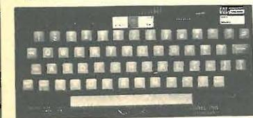
Tastiera in ASCII code, TTL compatibile per applicazioni OEM, HOBBY, SCUOLE, MICROPROCESSORI, ecc.
