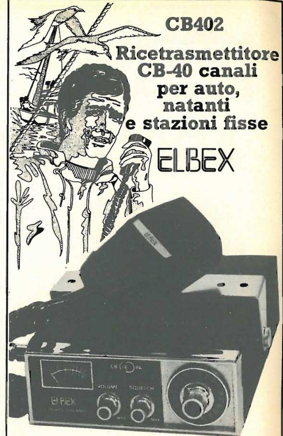
Il "CB402" è un ricetrasmittitore operante sulla banda cittadina (CB) in AM - 27 MHz. Utilizza un circuito sintetizzatore di frequenza in PLL per generare con precisione la frequenza dei 40 canali. Funziona sia su mezzi veicolari, sia in stazione fissa con alimentatore esterno a 13,8 Vc.c. stabilizzati.
